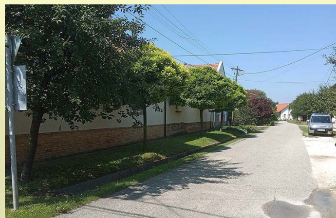
6. kép. Egyoldali, fenékburkolatú árku utca, árnyékoló fasorral. - Tápe, Veres P. u. - nyugati oldal (fotó: Korom A.)
